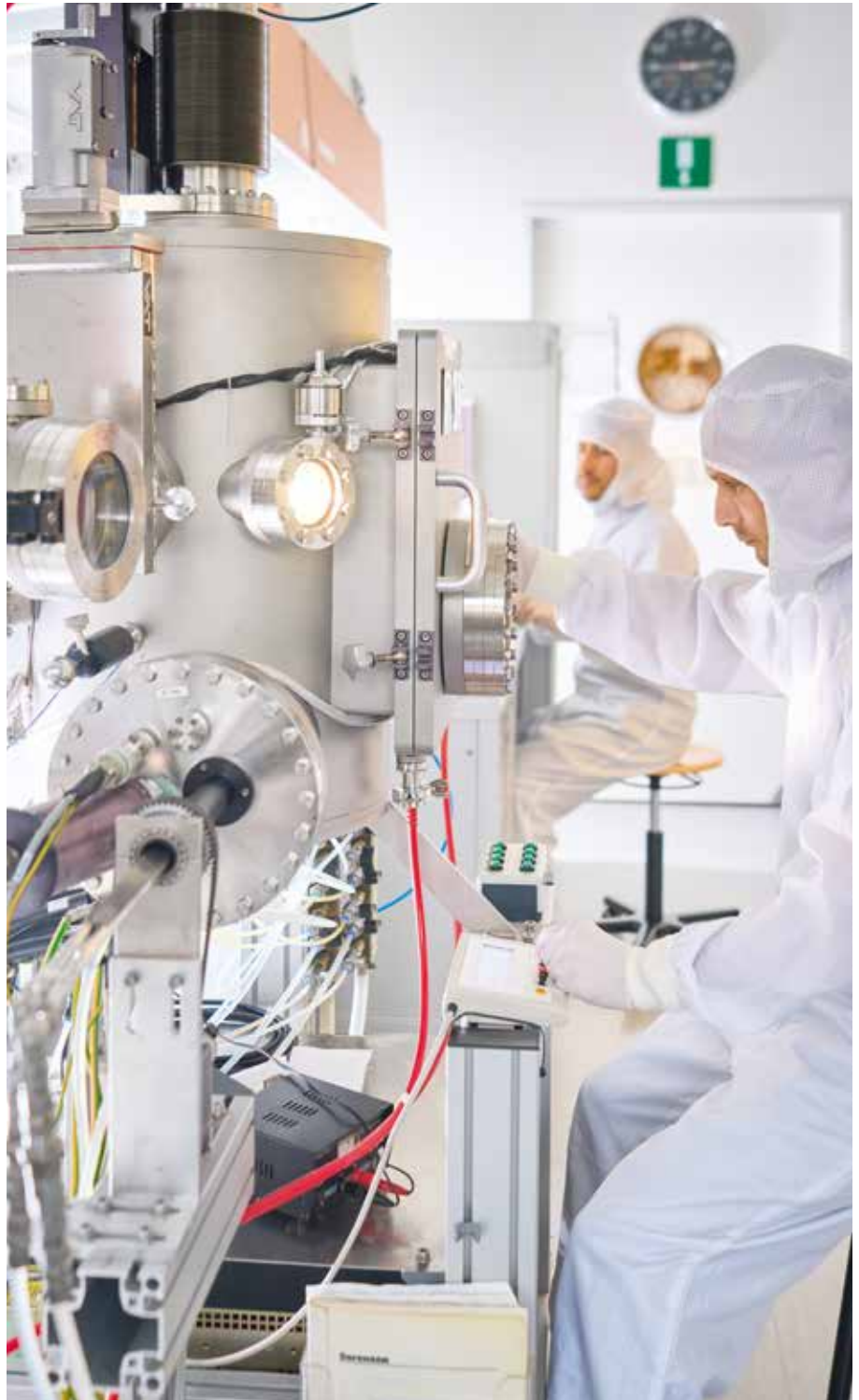
Untersuchung von zweilagigem Graphen im Reinraum: Um Eigenschaften des Kohlenstoff-sandwichs zu vermessen, muss es auf minus 272 Grad Celsius gekühlt sein. Foto: Jan Greune
