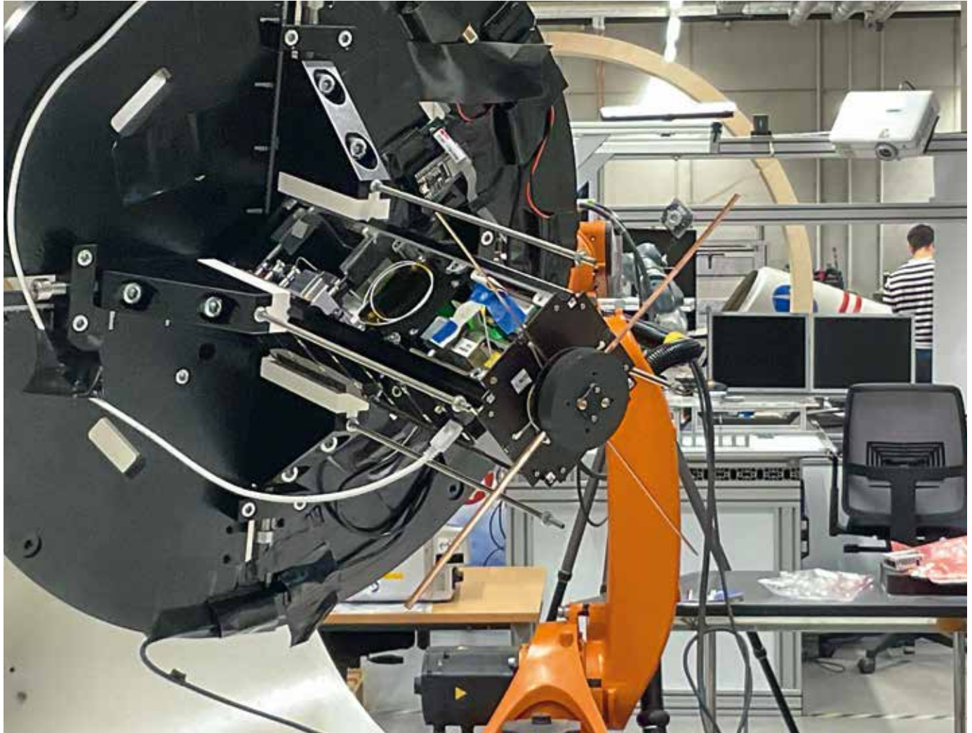
Testlauf im Labor: Im Zentrum für Telematik (ZfT) Würzburg prüfen Experten den Minisatelliten QUBE. Zentral ist es später, dass sich QUBE im All hochpräzise ausrichten lässt. Foto: ZfT
