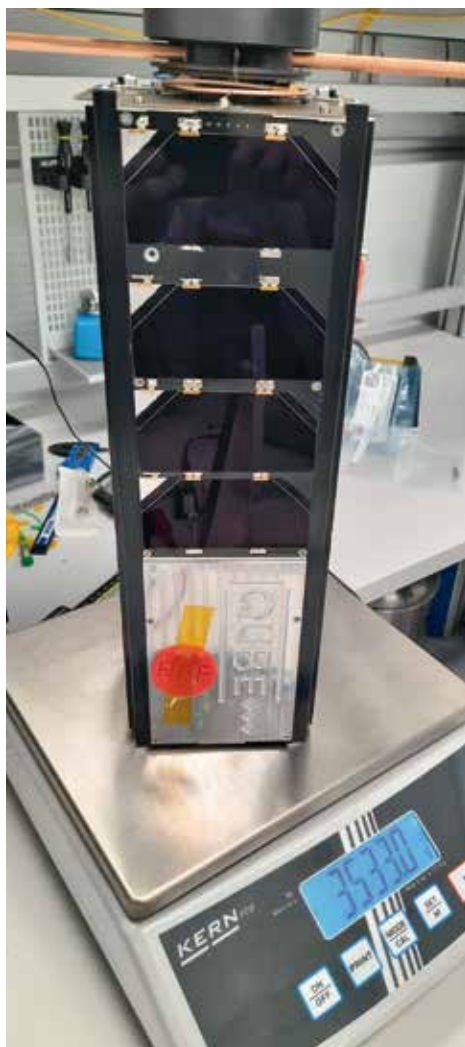
Gewogen und für gut befunden: 3,533 Kilogramm schwer ist der Minisatellit, für den Harald Weinfurter (rechts) gemeinsam mit Lukas Knips neue Prozessor-Boards entwickelt hat, die den Austausch der Quantenschlüssel steuern. Fotos: ZfT, Christoph Hohmann / LMU / MCQST
